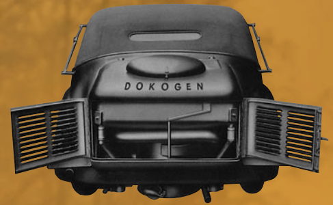
Skoda Superb echipată cu generator DOKOGEN în anul 1943
